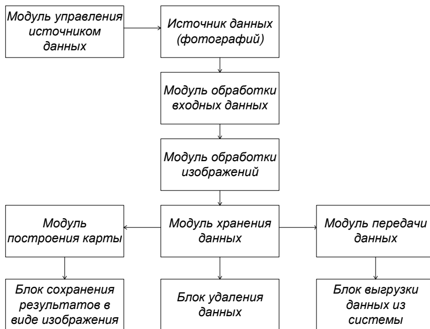
Рисунок 1 – Структурная схема мобильного приложения
